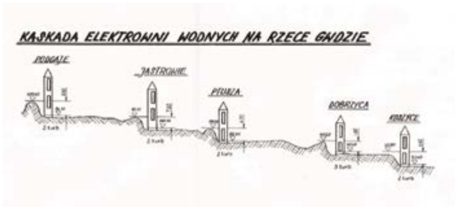
Kaskada elektrowni wodnych na Gwdzie
