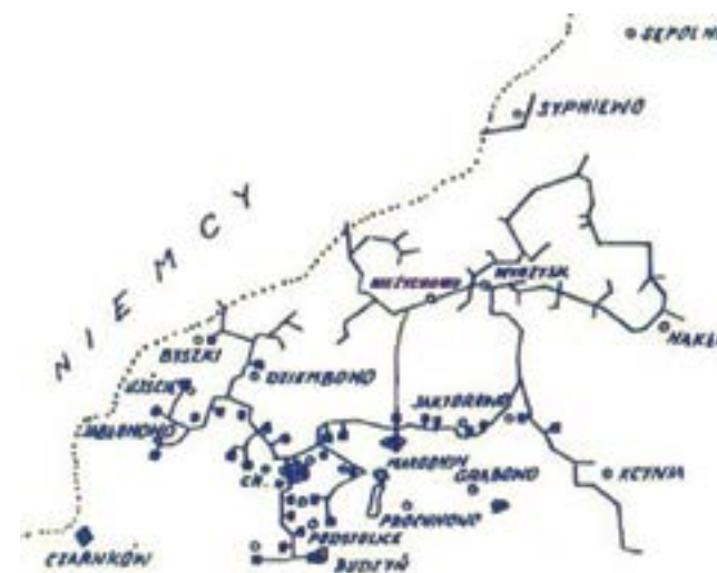
Układ schematyczny sieci 15 kV Centrali Elektrycznej Chodzież, wycinek mapy wg stanu z roku 1930
